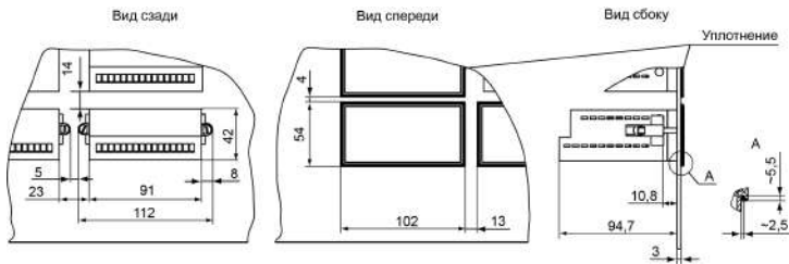
Рисунок 4.3 – Прибор в корпусе Щ2, установленный в щит толщиной 3 мм
